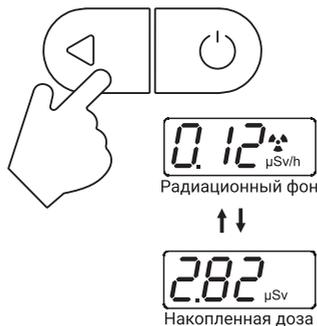
Переход между режимами измерения радиационного фона и накопленной дозой осуществляется кратковременным нажатием кнопки режимов
