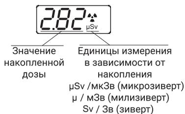
В режиме отображения накопленной дозы на дисплее отображается её текущее значение с момента последнего сброса или последней установки элементов питания
