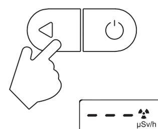
Для сброса накопленной дозы, в режиме её отображения, необходимо нажать и удерживать кнопку режимов (на индикаторе будут мигать сегменты " --- ", при дальнейшем удержании кнопки произойдет сброс накопленной дозы)
