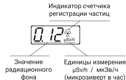
В режиме измерения радиационного фона на дисплее отображается его текущее значение
