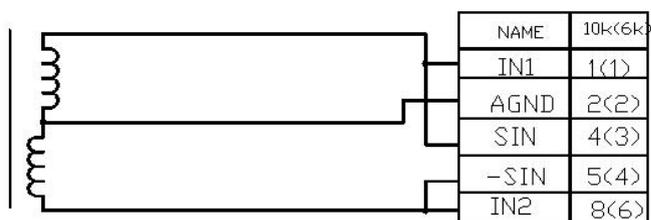
б) подключение параметрического датчиков типа "кубик", дифференциального двух катушечного или с компенсирующей катушкой
