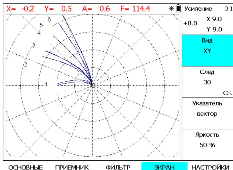
Рис.2-12 Изображение годографов на экране дефектоскопа при установке на образцы из стали с цинковыми покрытиями различной толщины:
