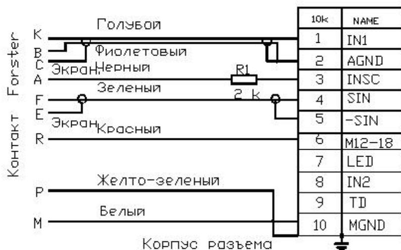
б) подключение ротационного датчика Forster
