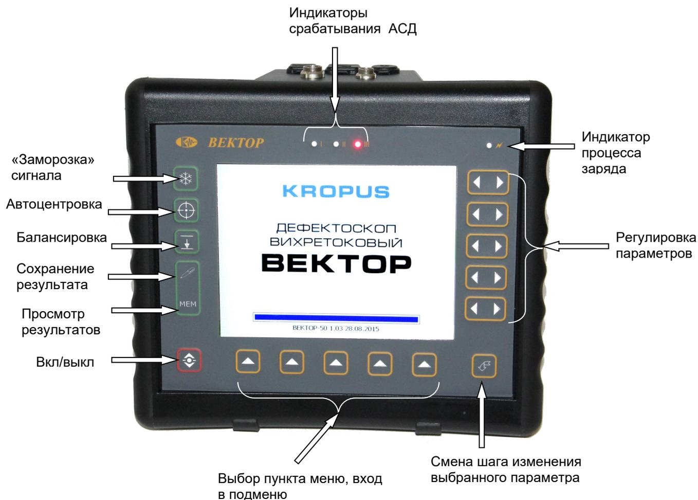
Рис 1-3—Клавиатура дефектоскопа
