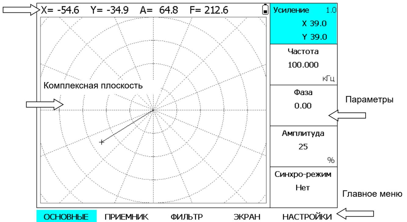
Рис 2-1 —Экран дефектоскопа
