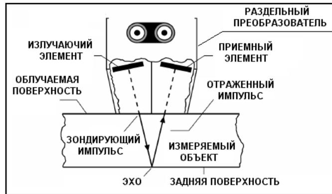
Рис. 6.23 Раздельно-совмещенный преобразователь
