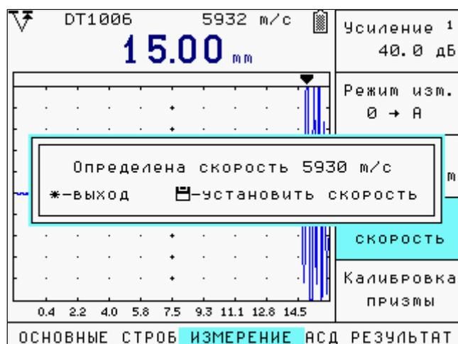
Рис.6.16 Измерение скорости распространения УЗК в образце
