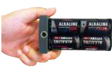
б) Вставить батареи в отсек, соблюдая полярность
