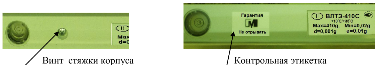
Рисунок 2 - Схема пломбирования от несанкционированного доступа
