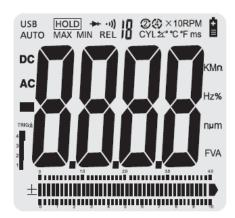
**AC DC** Нажать кнопку MODE и выбрать режим переменного тока (AC) или постоянного тока (DC)
