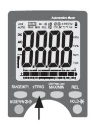
Переключение между положительным «+» и отрицательным «-» фронтом сигнала выводятся в нижнем левом углу ЖК-экрана.
