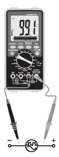
**4-8. Режим измерения – длительность замкнутого состояния прерывателя (**  $\overset{\wedge}{\triangle}$  ) Выбрать режим «**DWELL**» поворотом переключателя режимов.
