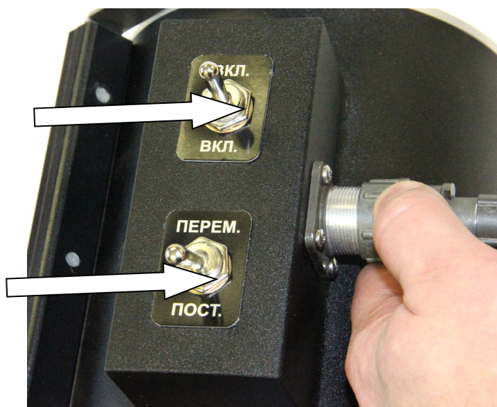
Рис. 5.6 Подключение провода и управление соленоидом
