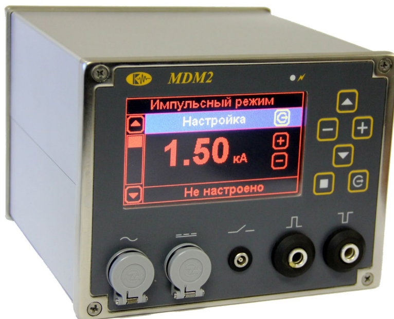
Рис. 4.1 Внешний вид дефектоскопа МДМ-2
