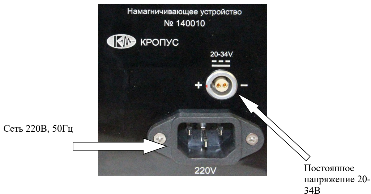
Рис. 4.2 Задняя панель дефектоскопа МДМ-2
