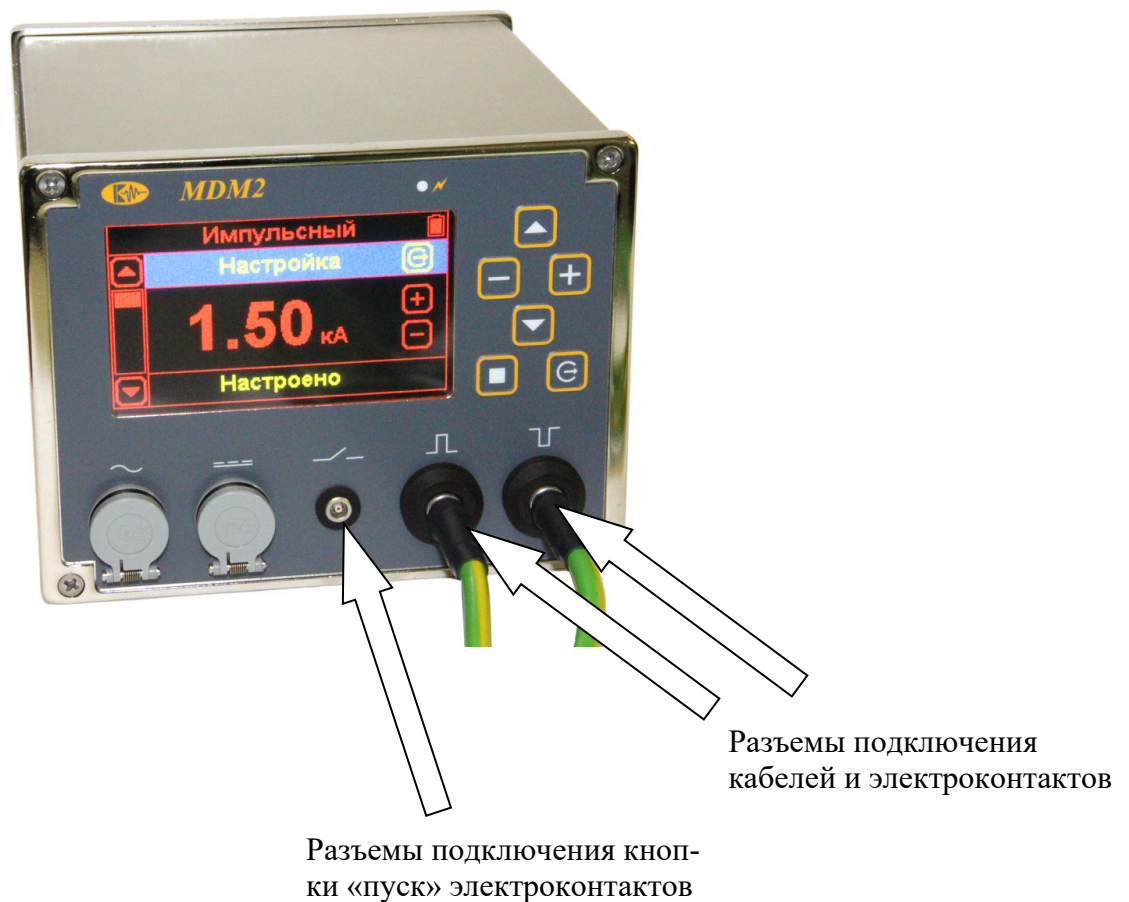
Рис. 5.1 Импульсный режим работы
