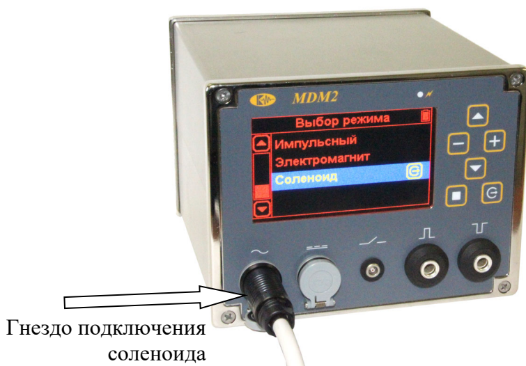
Рис. 5.5 Подключение соленоида к дефектоскопу
