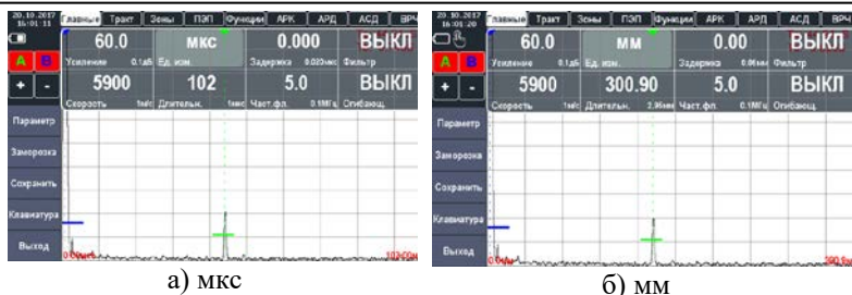
Рисунок 2.14 – Установка единицы отображения настроек и параметров дефектоскопа
