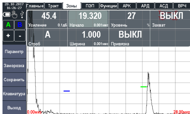
Рисунок 2.23 – Установка начала строба
