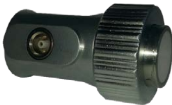
Рисунок 1.3 – Внешний вид прямого совмещенного преобразователя
