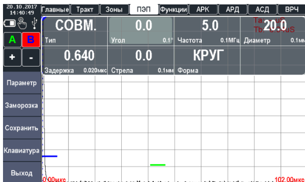
Рисунок 2.11 – Установка угла ввода УЗК
