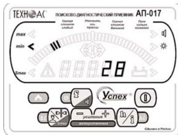
Для перехода в режим поиска по минимуму необходимо нажать на соответствующую кнопку. При этом на шкале высвечиваются 3 сегмента, а их положение указывает с какой стороны и на каком удалении находится ось коммуникации (на рисунке коммуникация находится слева). Стрелки не используются. Цифровое значение соответствует сигналу с вертикальной антенны и над осью должно принимать минимальное значение.
