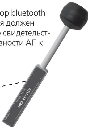
4. После включения питания АП находится в режиме ожидания соединения с устройством отображения результатов измерений.
