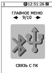
Данный режим используется для передачи результатов измерений параметров окружающей среды (ЭМП, микроклимата) из памяти блока НТМ-Терминал в ПО «НТМ-ЭкоМ», подготовки к обновлению ПО блока НТМ-Терминал, настройки главного меню.
